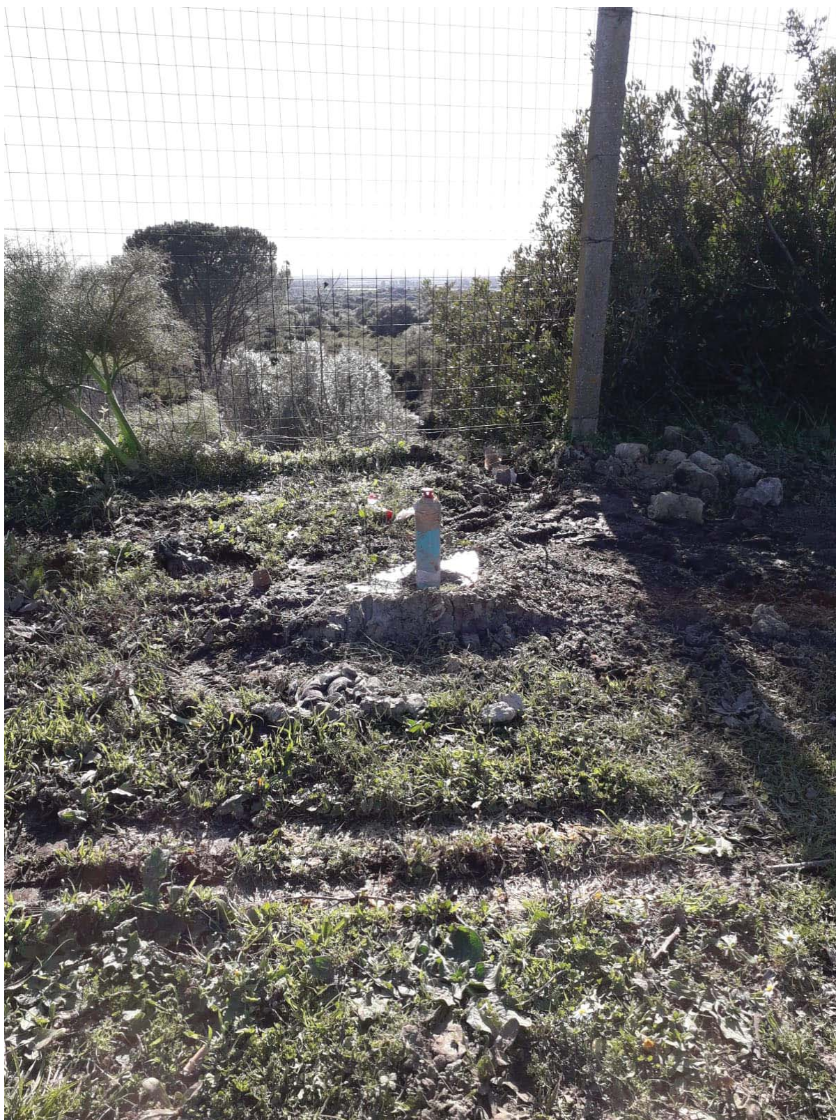
Fig.29: Sondaggio geognostico S1 - Diga Mura Cabonis – Allestimento Piezometro
