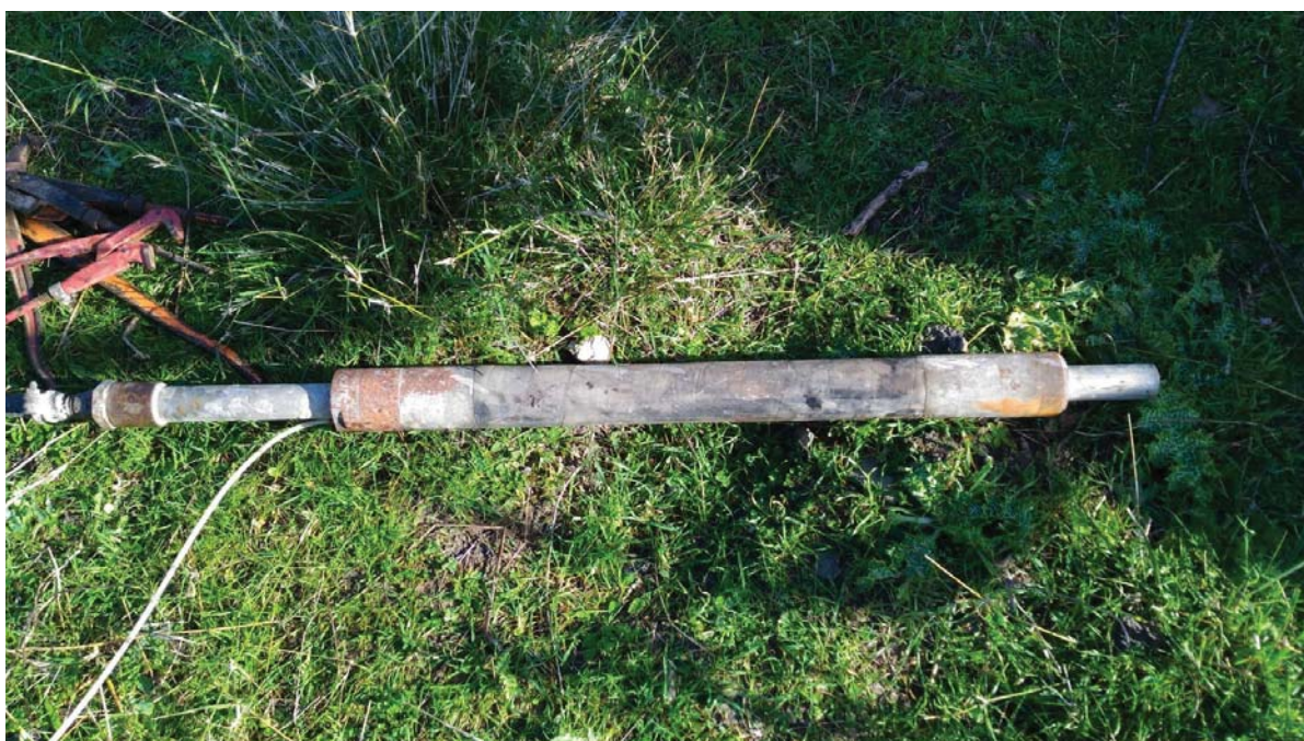
Fig. 36: Packer per esecuzione prova Lugeon
