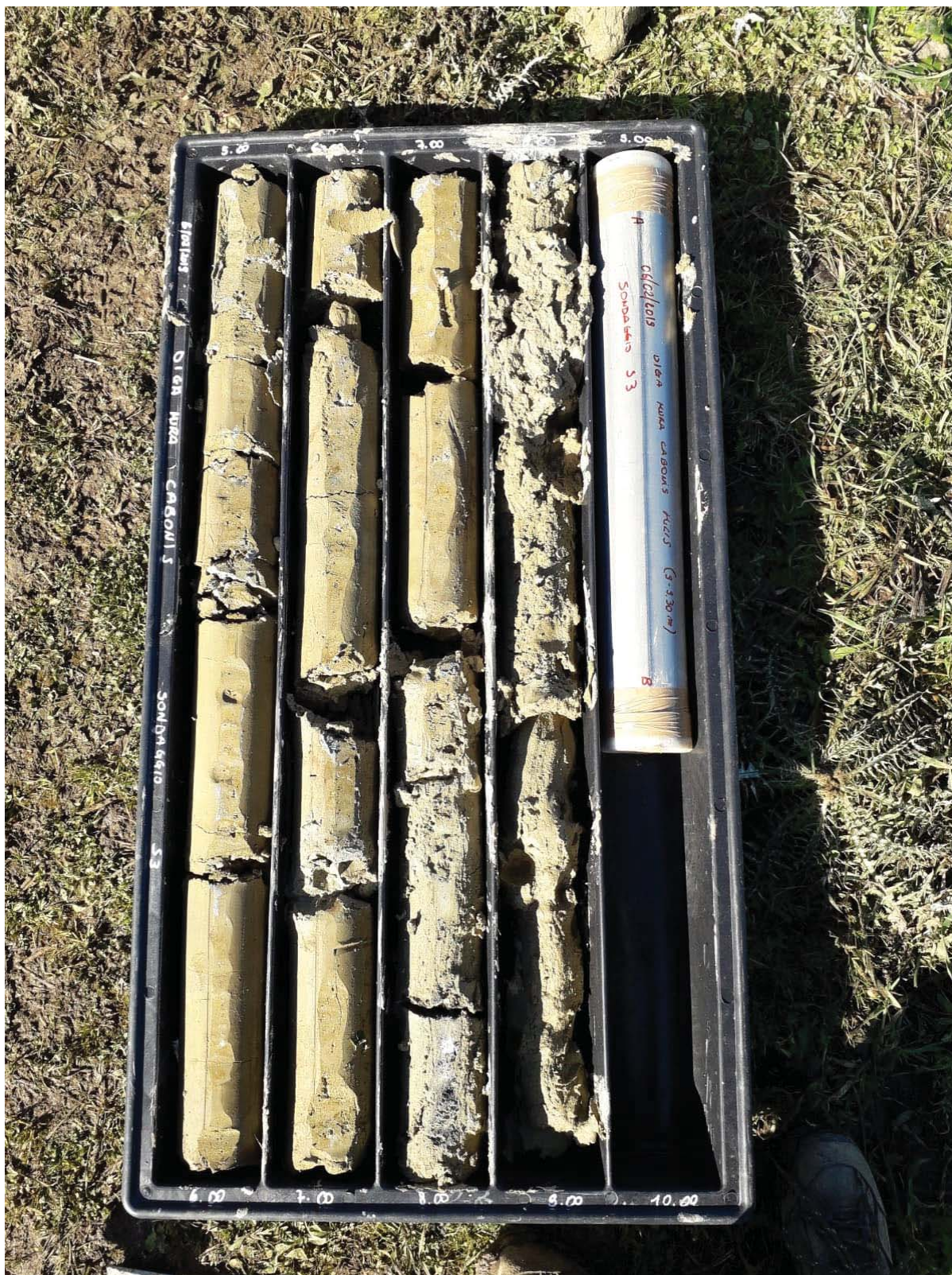
Fig.25: Sondaggio geognostico S3 - Diga Mura Cabonis – 5.00 m ÷ 10.00 m
