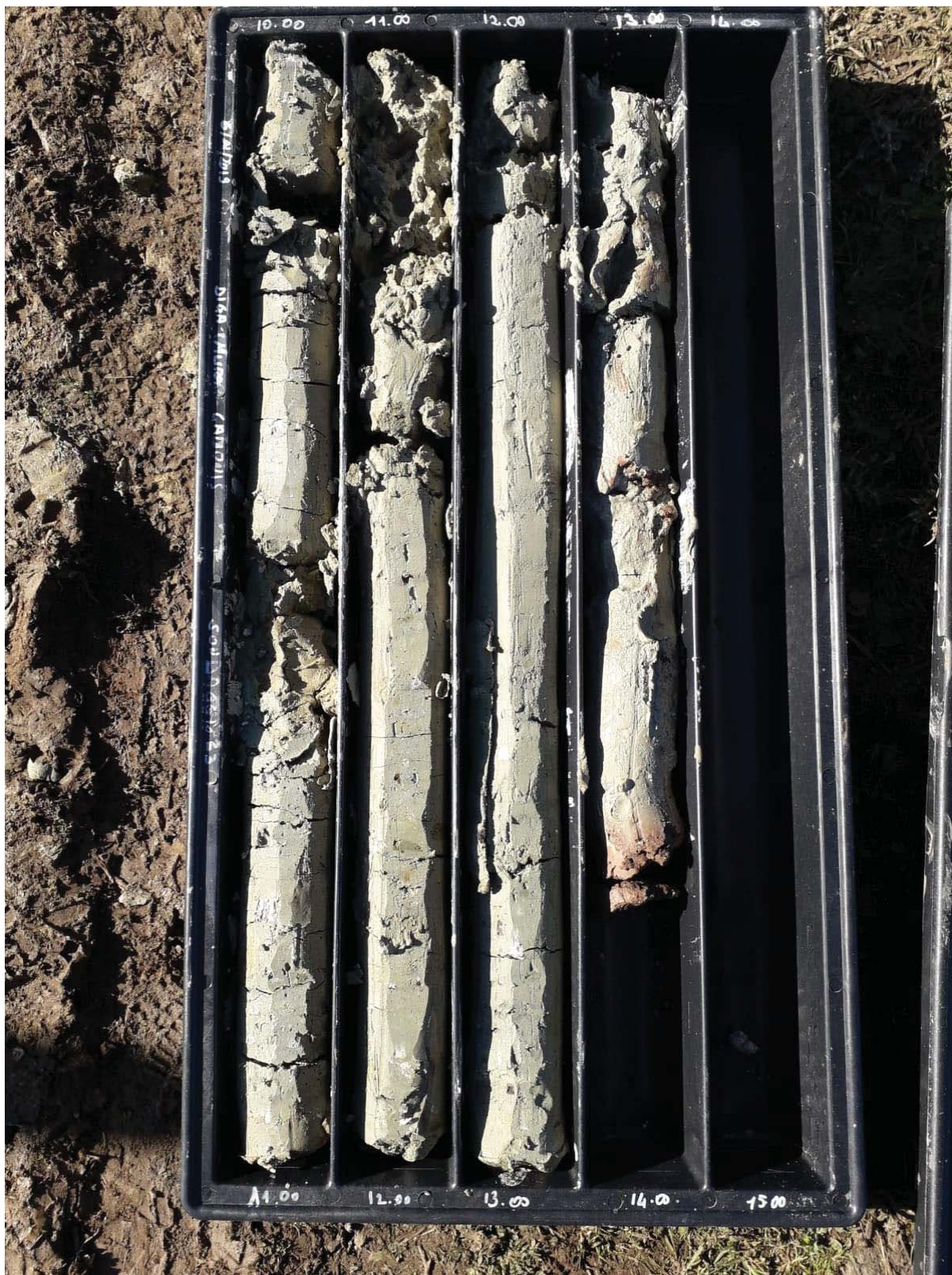
Fig.26: Sondaggio geognostico S3 - Diga Mura Cabonis – 10.00 m ÷ 13.90 m
