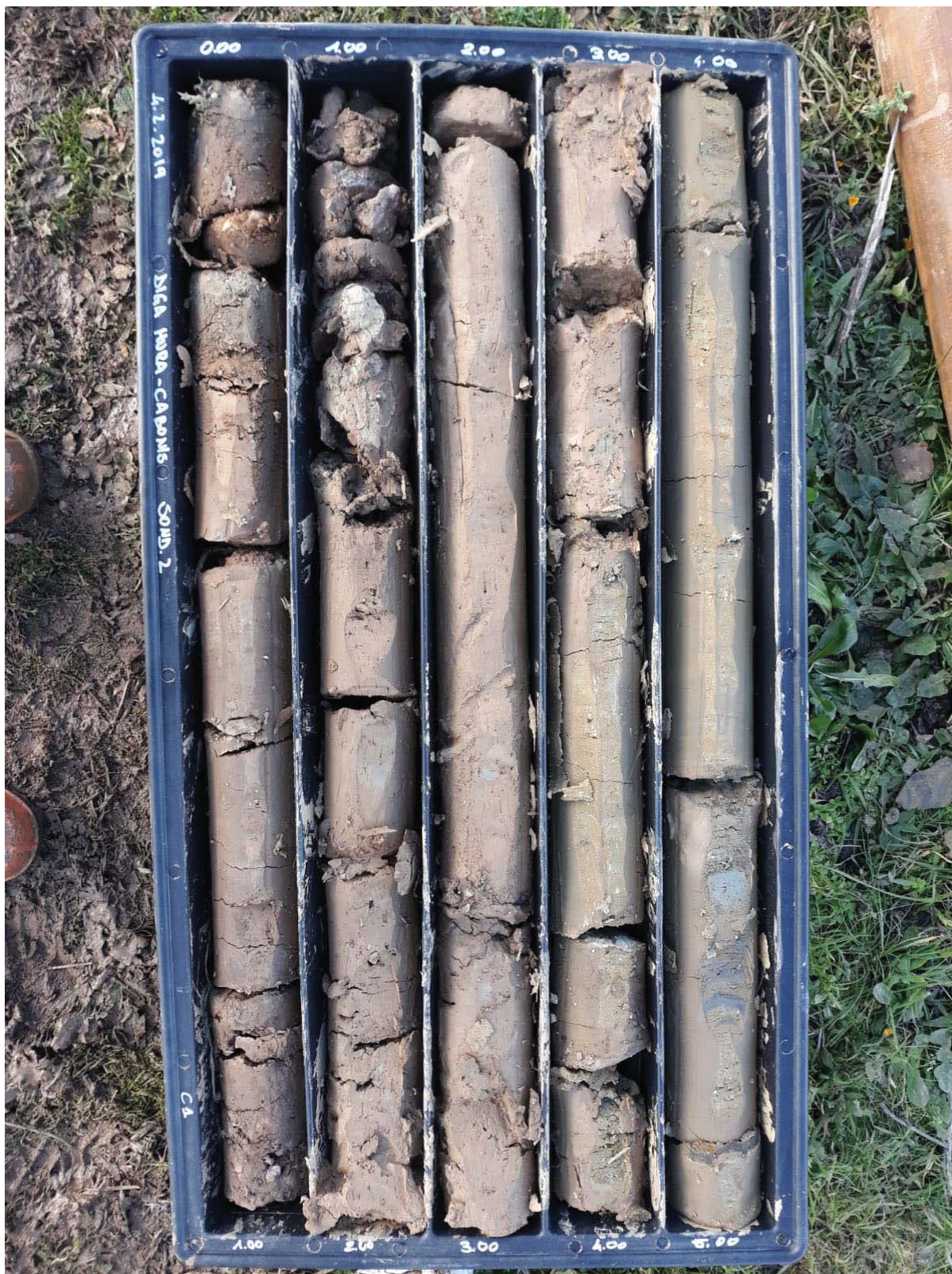
Fig.20: Sondaggio geognostico S2 - Diga Mura Cabonis – 0.00 m ÷ 5.00 m
