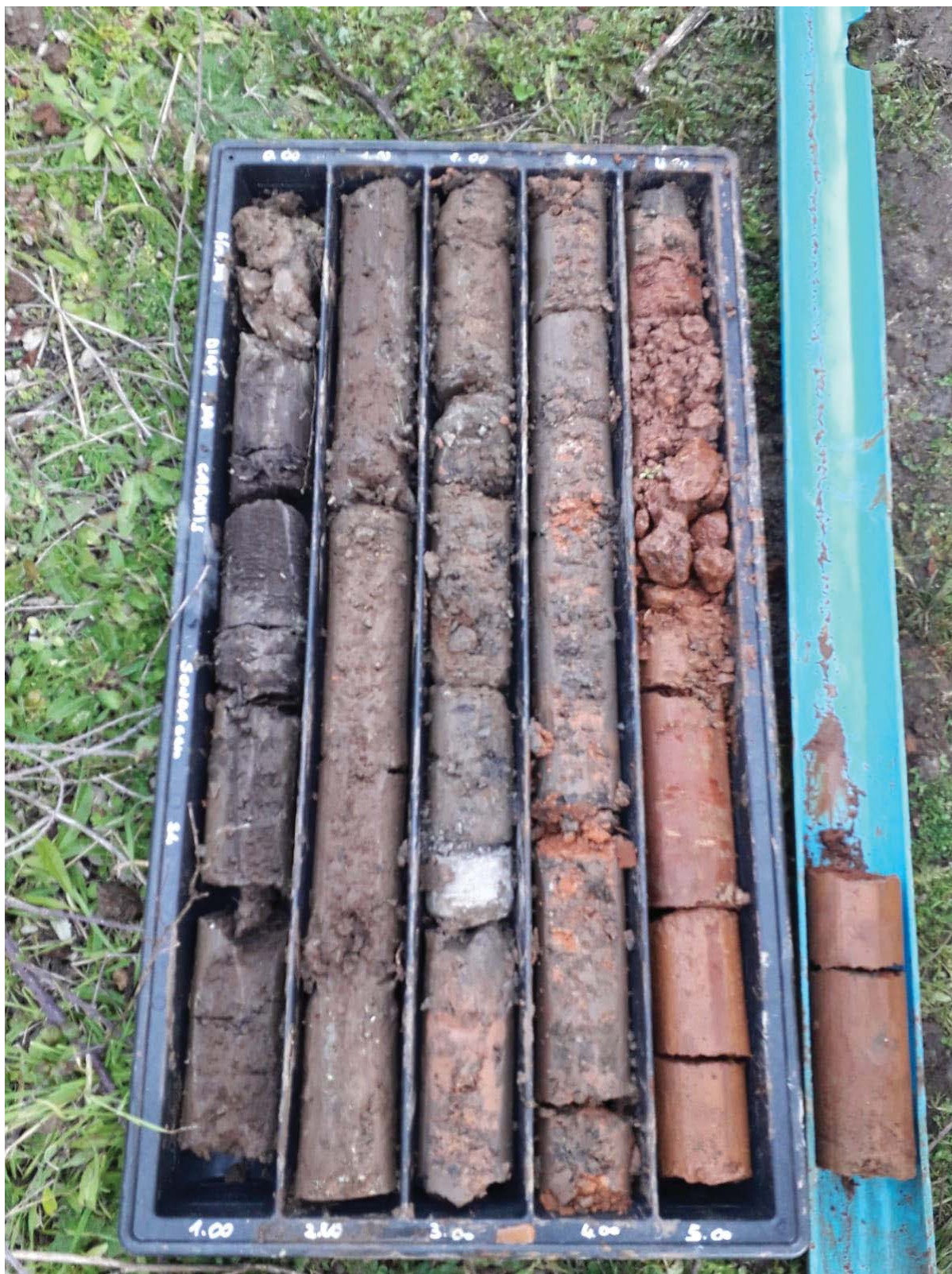
Fig.27: Sondaggio geognostico S4 - Diga Mura Cabonis – 0.00 m ÷ 5.10 m
