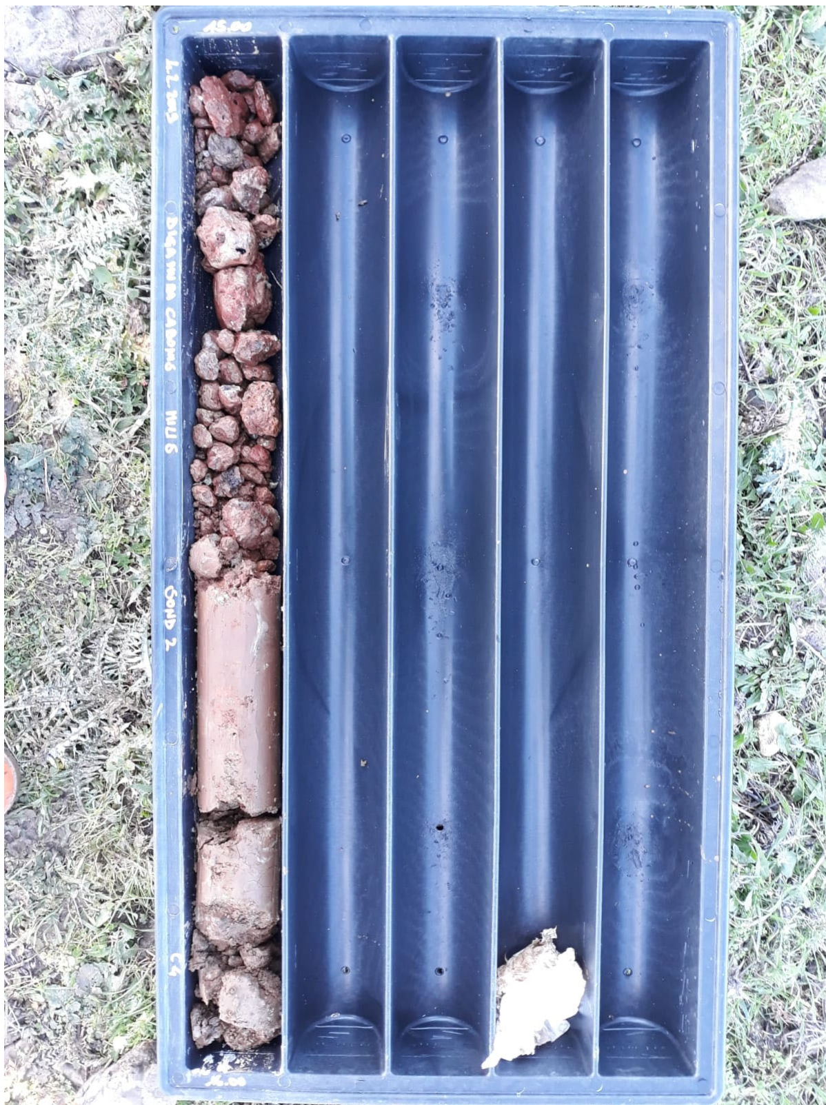
Fig.23: Sondaggio geognostico S2 - Diga Mura Cabonis – 15.00 m ÷ 16.00 m
