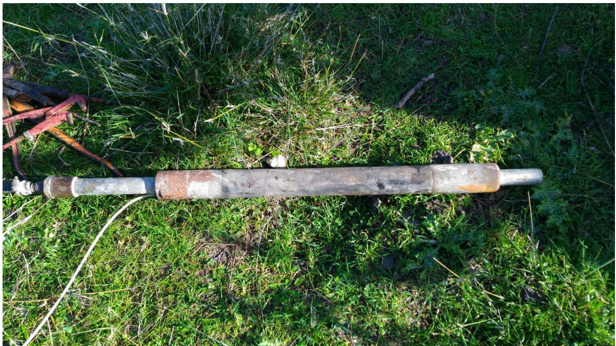
Fig. 36: Packer per esecuzione prova Lugeon
