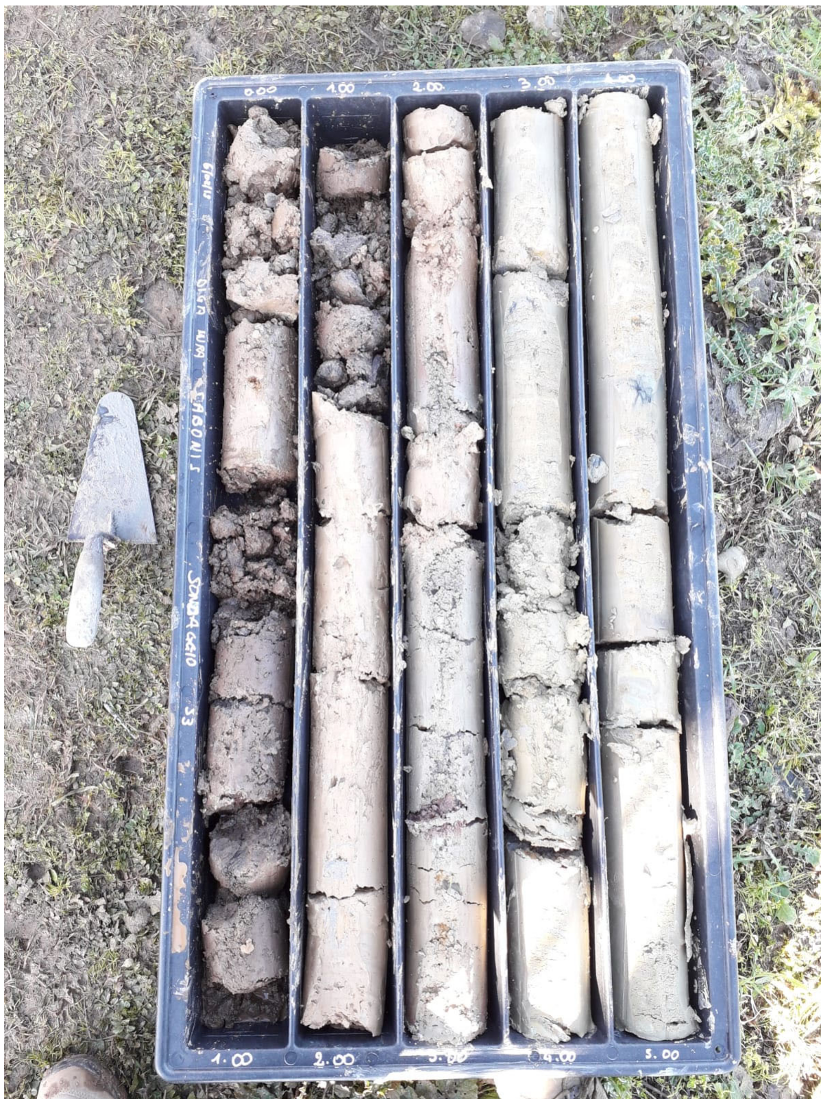
Fig.24: Sondaggio geognostico S3 - Diga Mura Cabonis – 0.00 m ÷ 5.00 m
