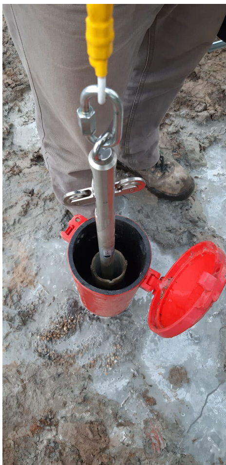
Fig.32: Sondaggio geognostico S2 - Diga Mura Cabonis – Passaggio sonda testimone per rilievo discontinuità
