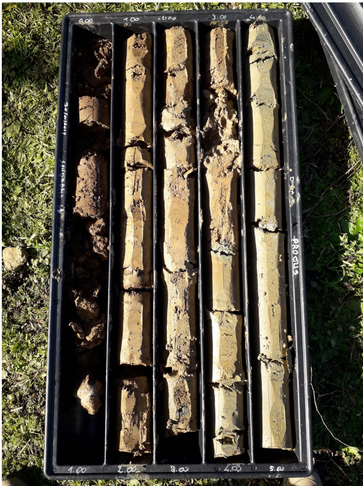
Fig.16: Sondaggio geognostico S1 - Diga Mura Cabonis – 0.00 m ÷ 5.00 m
