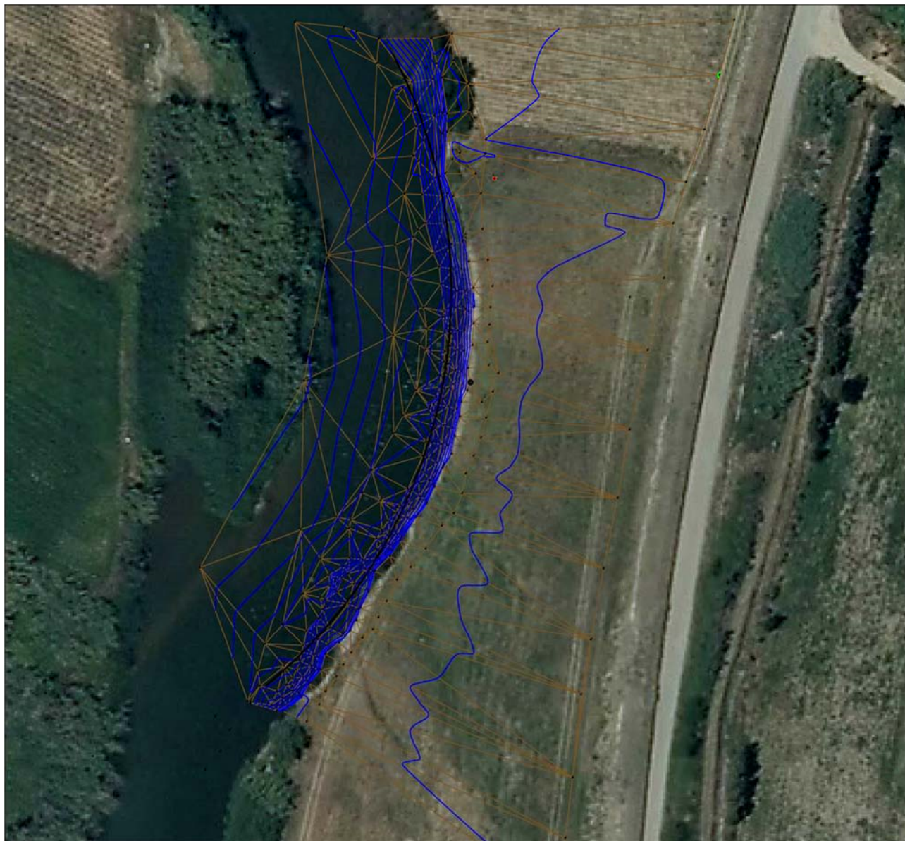
Fig. 7 - Configurazione plano-batimetrica (in blu le curve di livello)
