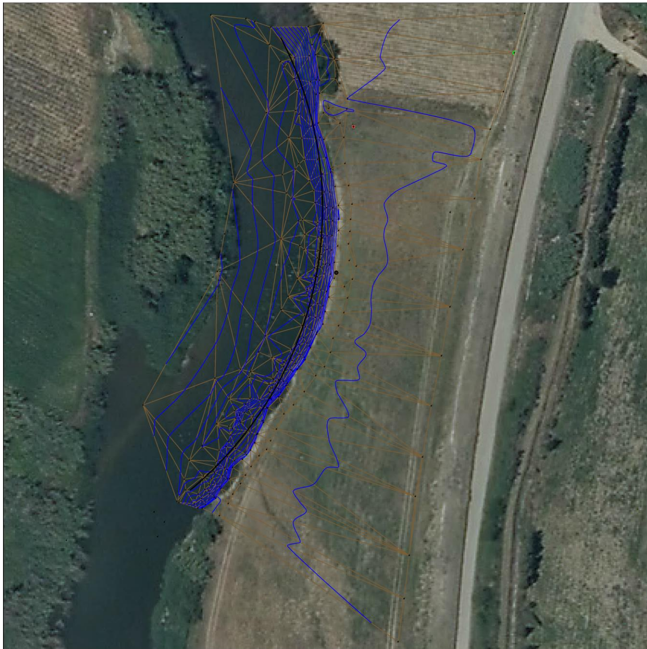
Fig. n. 8 – Planimetria campagna indagini plano batimetrica (in blu le curve di livello).
