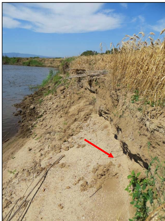
Foto 6 - Livello sabbioso intercalato nei banchi di limi sabbio-argillosi
