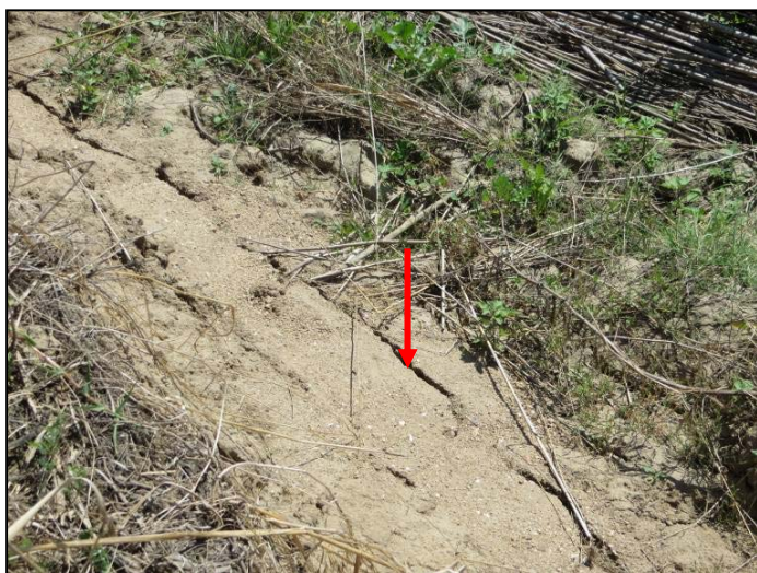
Foto 5 - Frattura di trazione sull'orlo della scarpata fluviale
